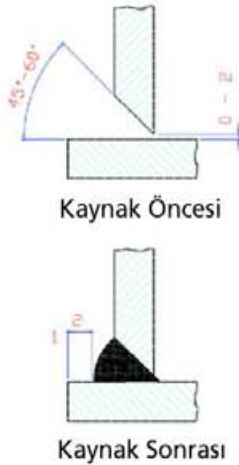
Şekil 8.5 Köşe Kaynağı Dik Parça Kaynak Şekilleri
